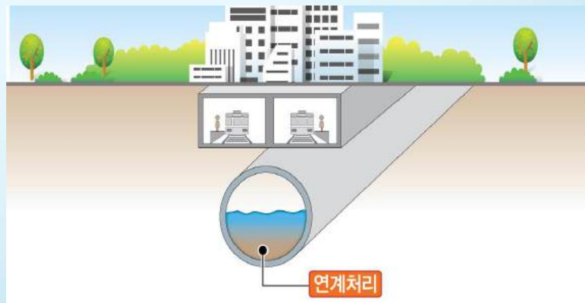
<터널형 저류시설 설치>
